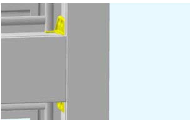
T-Profil horizontal eingesetzt
